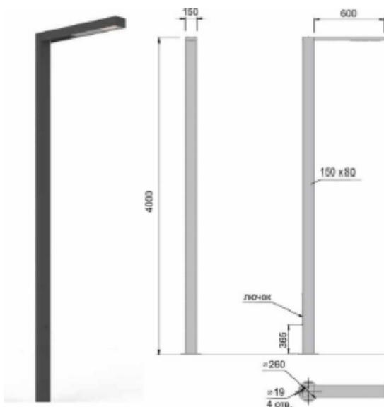
Светодиодный светильник типа «Фотон», опора электроосвещения металлическая.
